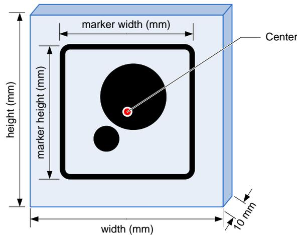
**Figure 94:** The custom wall parameters
